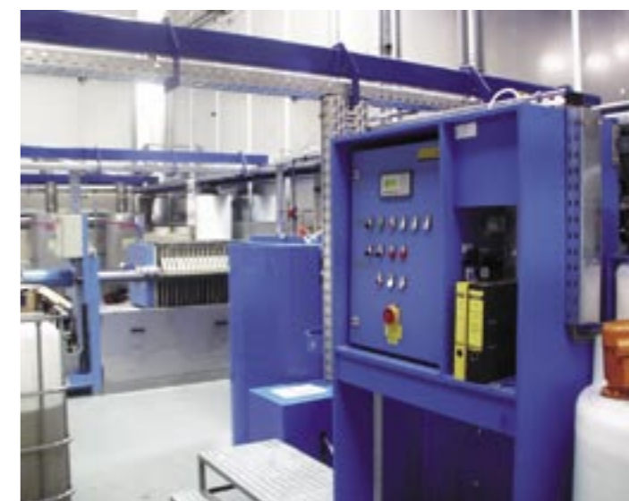
AWAS флотация и шламоосушающий камерный фильтр-пресс для очистки стоков с территорий предприятий, на которых складировается и перегружается металлолом, покрытый эмульсиями.
